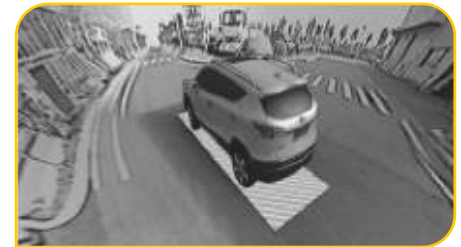
تصویر ۹، تصویر سه‌بعدی عقب چپ و گردش به چپ است، دسته دنده در موقعیت دنده عقب قرار ندارد
