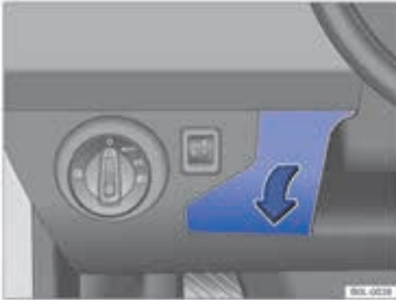
شکل ۱۲۶ : داشبورد در قسمت راننده: کاور جعبه فیوز
