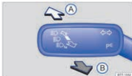
شکل ۶۶ : در سمت چپ ستون فرمان: اهرم کنترل نور بالای چراغ جلو/چراغ راهنما
