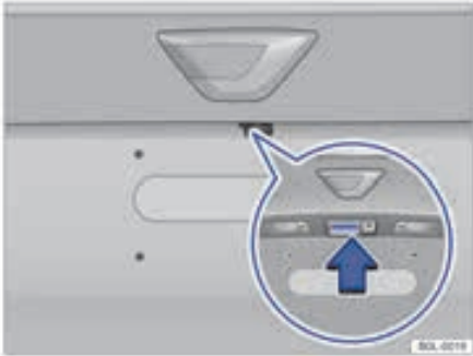
شکل ۴۹: باز کردن درب صندوق عقب از بیرون
