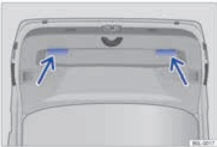
شکل ۵۰: درب صندوق عقب باز شده: دستگیره فرورفته برای بستن درب صندوق عقب
