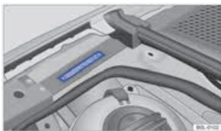
شکل ۱۶۳ : در محفظه موتور: کد شناسایی خودرو (نمودار شماتیک)
