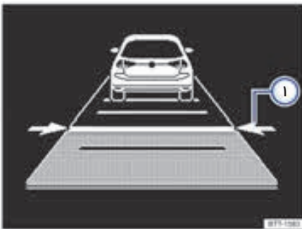
شکل ۹۸: صفحه کیلومتر: تنظیم فاصله (نمای شماتیک، تنظیم ACC)
