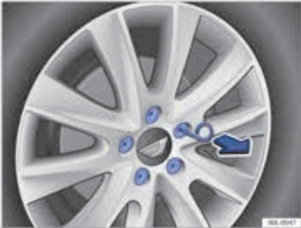
شکل ۱۵۴: درآوردن کلاhek محافظتی از پیچ چرخ (نمودار شماتیک)
