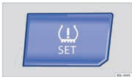
شکل ۱۴۶ : کنسول مرکزی: دکمه مانیتورینگ فشار لاستیک
