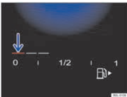
شکل ۱۳: نشانهگر میزان سوخت در صفحه کیلومترشمار دیجیتال
