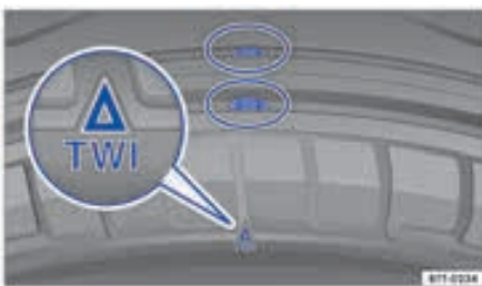
شکل ۱۵۰ : الگوی لاستیک: علامت های فرسودگی (نمودار شماتیک)
