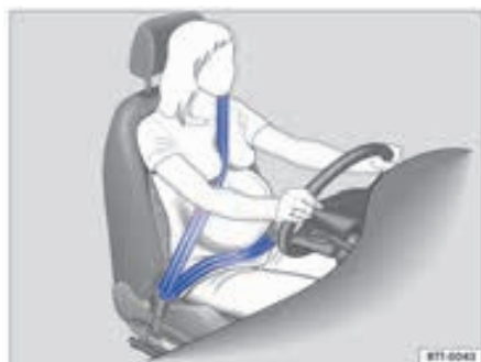
شکل ۲۸: روش درست بستن کمربندهای ایمنی برای زنان باردار
