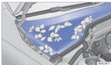
شکل ۱۵۹: بین محفظه موتور و شیشه: شیار تخلیه (نمودار شماتیک)
