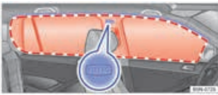
شکل ۳۳ : سمت چپ خودرو: موقعیت نصب و محدوده عملکرد کیسه هوای سر
