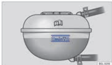
شکل ۱۴۱: در محفظه موتور: علامت مخزن انبساط مایع خنک کننده موتور (نمای شماتیک)
