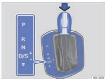
شکل ۸۸ : اهرم دنده اتوماتیک مجهز به دکمه قفل (فلش)
