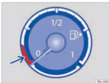
شکل ۱۲: نشانهگر میزان سوخت در صفحه کیلومتر شمار آنالوگ
