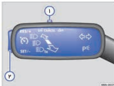
شکل ۹۲: سمت چپ ستون فرمان: سوئیچ ها و دکمه ها برای کنترل GRA
