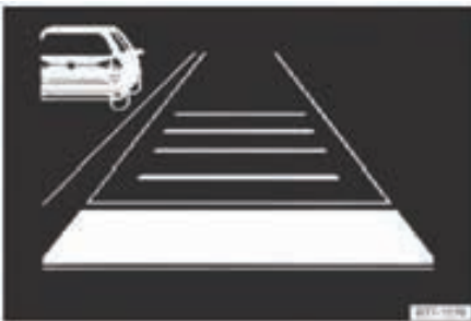
شکل ۹۴: در صفحه کیلومتر، وسیله نقلیه با سرعتی پایین تر از سرعت وسیله نقلیه در خط سمت چپ، مشخص می شود. (نمای شماتیک)
