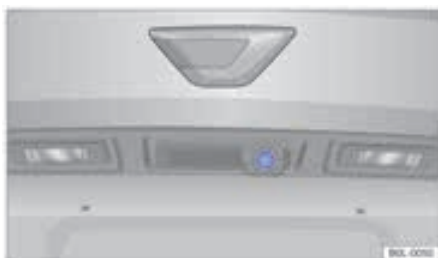
شکل ۱۶۰: روی درب عقب: دوربین دنده عقب (نمای شماتیک)
