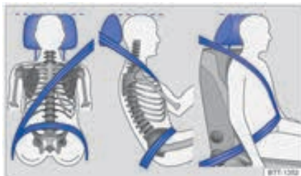
شکل ۲۷: وضعیت درست کمربند ایمنی و پشت‌سری
