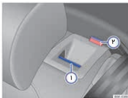
شکل ۵۷ : در پشتی ردیف عقب: دکمه باز کردن قفل
