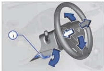
شکل ۵۳: بر روی پانل تریم ستون فرمان زیر فرمان: اهرم برای تنظیم مکانیکی موقعیت فرمان
