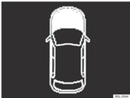
شکل ۱۳۷ : صفحه کیلومتر: درب محفظه موتور باز است یا به درستی بسته نشده است
