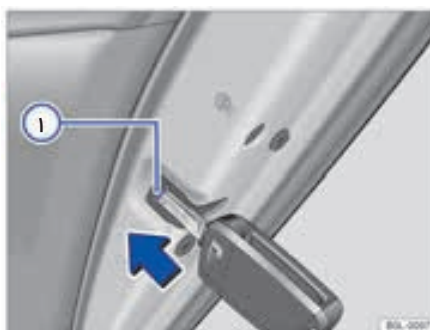
شکل ۴۷ : کنار دستگاه قفل درب دست‌راست: قفل کردن خودرو با کلید اضطراری
