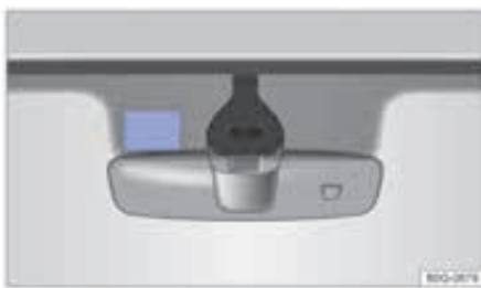
شکل ۱۶۱: پنجره ارتباطی روی شیشه (قسمت آبی) (نمودار شماتیک)
