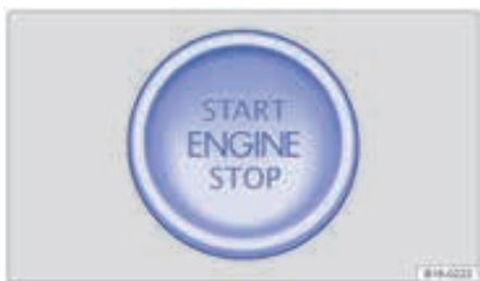
شکل ۸۴: بخش پایینی کنسول مرکزی: دکمه روشن/ خاموش برای استارت زدن موتور
