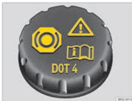
شکل ۱۴۳ : محفظه موتور: درپوش مخزن روغن ترمز
