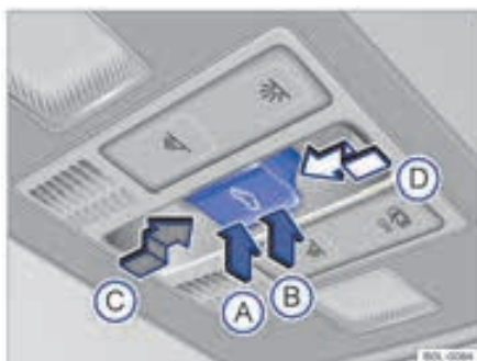
شکل ۵۲: دکمه‌هایی برای باز و بستن سانروف برگردان / کشویی پانورامایی برقی
