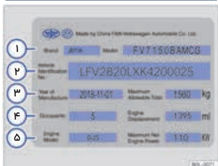
شکل ۱۶۲: صفحه اطلاعات وسیله نقلیه (نمودار شماتیک)
