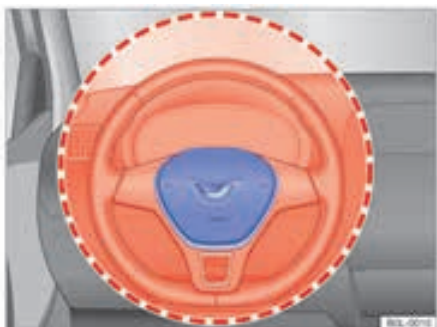
شکل ۲۹: موقعیت قرارگیری و محدوده کیسه هوای جلوی راننده
