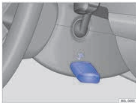
شکل ۸۵ : سمت راست ستون فرمان: عملکرد استارت اضطراری بر روی خودروهای مجهز به «دسترسی بدون کلید»
