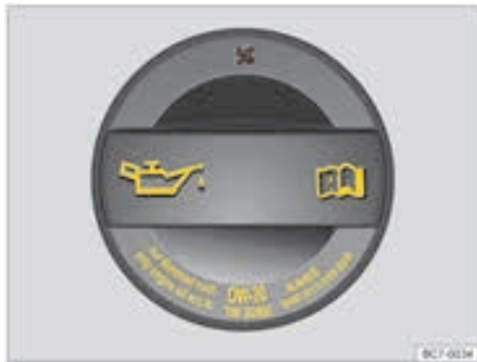
شکل ۱۴۰: در محفظه موتور: درپوش پرکننده روغن موتور (نمای شماتیک)
