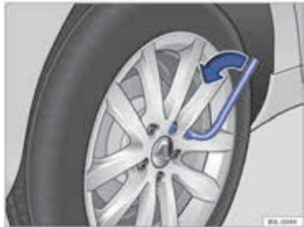
شکل ۱۵۸: تعویض چرخ: پیچ های چرخ را با آچار بکس پیچ چرخ بردارید
